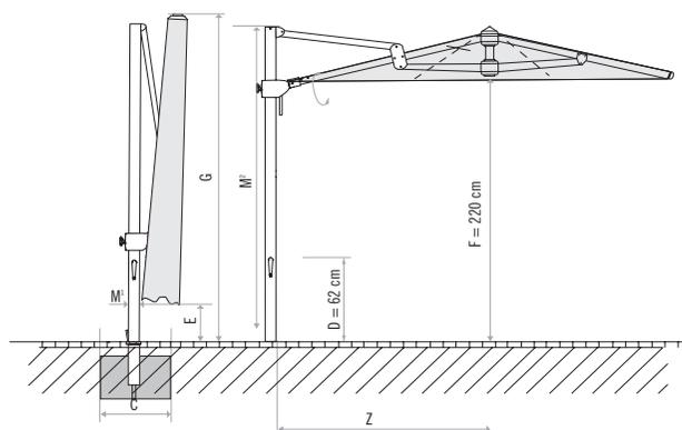
Losser Deckbelag max. 10 cm, Betondicke min. 30 cm
