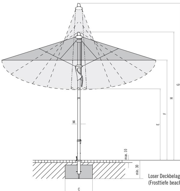
Looser Deckbelag max. 10 cm, Betondicke min. 30 cm
